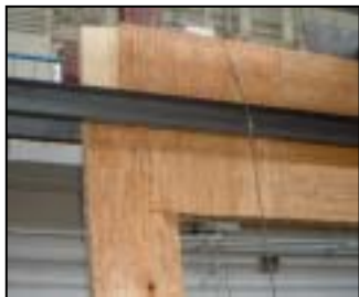
写真 - 1 充腹梁（加力側） [試験体：5M]
