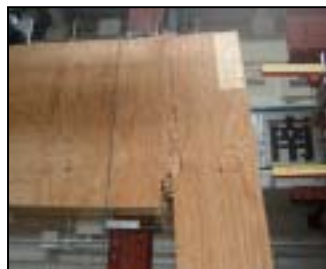
写真 - 2 充腹梁（非加力側） [試験体：5M]
