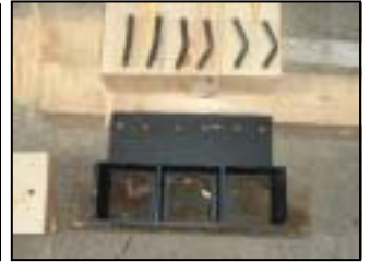
写真 - 4 合わせ柱脚接合金物 （非加力側） [試験体：5M]
